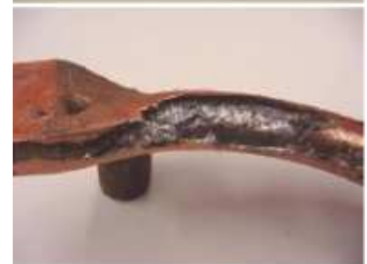
Şekil 5. Endükleme ile parçanın farklı bölgelerinde döküm kusurlarının tespiti
