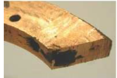
Şekil 4. Parlatılmış parça üzerindeki döküm kusurları
