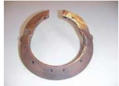
Şekil 4. Parlatılmış parça üzerindeki döküm kusurları
